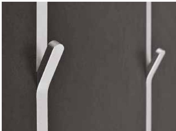
APPENDO est un listel décoratif vertical breveté avec la fonction de crochet intégré. Il peut être utilisé dans les salles de bains carrelées permettant d'obtenir un double effet décoratif et fonctionnel. Le listel est fixé au mur par des plaques métalliques de fixation. Les rondelles de compensation incluses dans le kit de montage, peuvent adapter le profilé, aux carreaux de 8, 10 et 12,5 mm.
